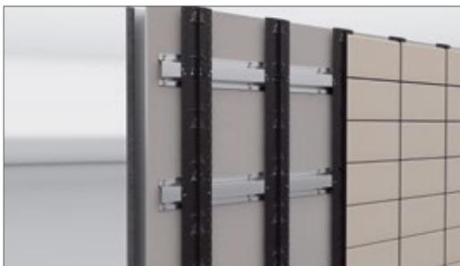
Fugenprofil einklipsen (für geschlossene Fugen)
