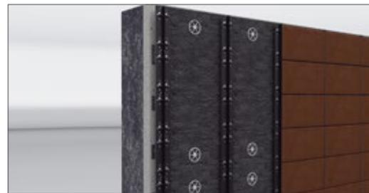
T-Profil mit zugelassenen Befestigungsmitteln montieren
